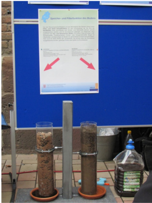
Demonstration der Versickerung auf verschiedenen Böden
